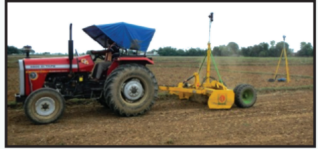
चित्र २ : लेजर ल्याण्ड लेभलरको प्रयोग गरी जग्गा सम्झाउनाले बाली एकनाशको हुन्छ, कम पानी लाग्छ, कम भारपात आँउछ, मलको बढी सदुपयोग हुन्छ, बाली एकै नाशले पाक्दछ, र उत्पादनमा पनि वृद्धि हुन्छ । यसले जग्गा सम्झाउँदा एक हेक्टरमा लगभग १३,००० देखि १५,००० रूपैयाँ खर्च लाग्छ तर ४-५ वर्षसम्म सम्झाउनु पर्दैन ।
