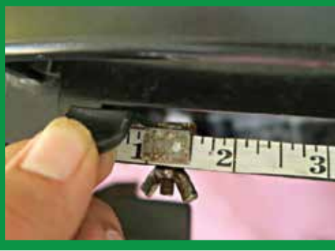
चित्र नं २. मल वा बीउ भर्ने प्वाल बन्द गर्नको लागि लिभरलाई पेचभन्दा अगाडि सारेको
